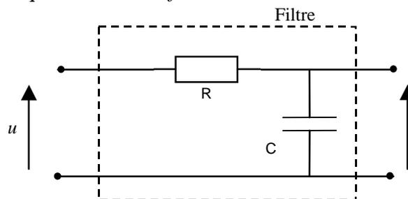
Ce filtre atténue ou « arrête » les tensions de fréquence supérieure à la fréquence  $f_0 = \frac{1}{RC\omega}$
